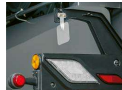
Датчик автомат. регулировки направления разбрасывания
