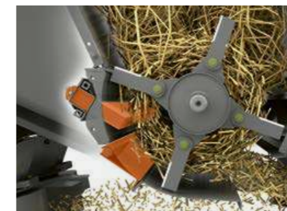
Противорезы и поворотный сектор днища в измельчителе SPECIAL CUT
