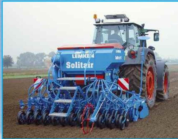
Солитэр 8 шириной захвата три и четыре метра является экономным решением при приобретении навесной не складываемой пневматической посевной техники. Солитэр 8 от ЛЕМКЕН дает возможность хозяйствам среднего размера применять недорогую точную пневматическую посевную технику с механическим приводом высевного вала и гидравлическим приводом пневмоторбины.
