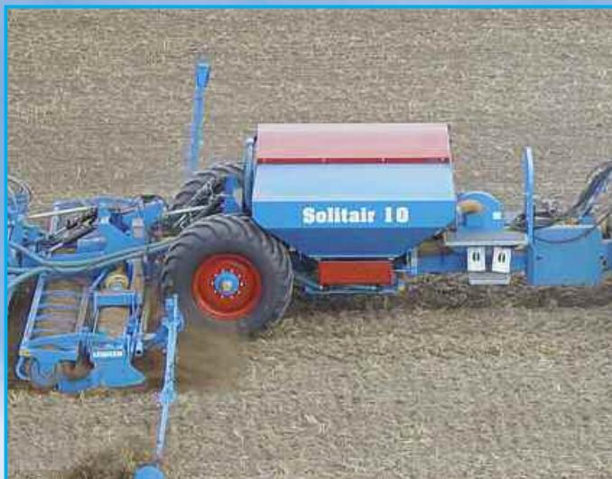
Большой семенной бункер Солитэр 10 объемом около 5.800 литров обеспечивает более длительную работу и снижает количество загрузок бункера. В Солитэр 10 могут объединяться преимущества полуавесной посевной комбинации с высокой производительностью прицепной пневматической сеялки Солитэр 12. Четыре дозировочных узла обеспечивают равномерный поток семян и хорошее поперечное распределение.
