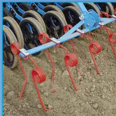
Опционально поставляемый штригель-S может применяться со всеми вариантами сошников. Как давление штригеля, так и интенсивность работы легко регулируется без применения инструментов. Для ряда штригельных зубьев служат для хорошего выравнивания и покрытия семян почвой.
