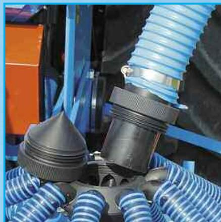
Для простой и быстрой очистки семенного бункера от остатков существует две возможности: для опустошения через нижнюю заслонку лоток пробного высева устанавливается под дозировочные узлы и семена попадают из семенного бункера через нижнюю заслонку в лоток пробного высева. При опустошении через распределитель, на него надевается шланг. Семеной бункер при этом опустошается при помощи воздуха, подаваемого пневмтурбиной.
