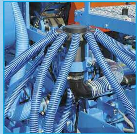
Распределители семян расположены снаружи семенного бункера, непосредственно над сошниковым бруском. Для точного распределения семян семенные трубы, соединяющие распределитель и сошник, максимально короткие и имеют одинаковую длину. Неизменное расположение с уклоном предотвращает забивания. Для осуществления контроля распределитель легко открывается.
