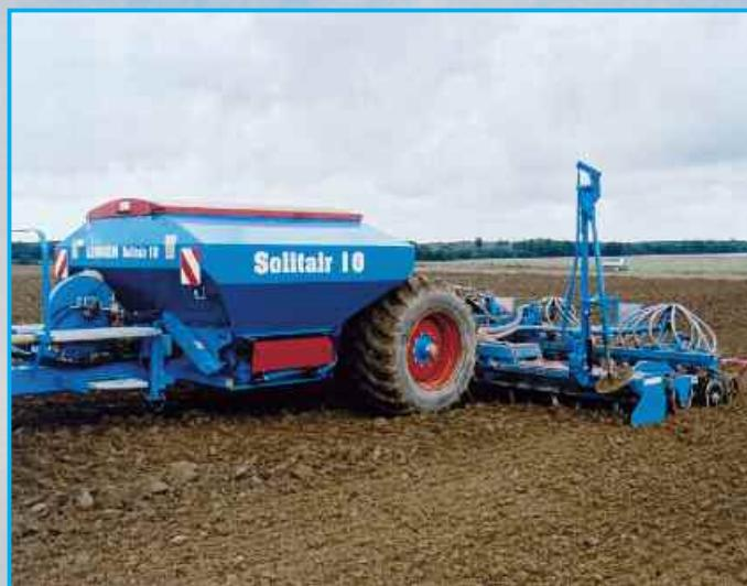
Солитэр 10 от ЛЕМКЕН является прицепной посевной комбинацией для достижения высочайшей производительности и экономичности. Прицепной бункер для семян со стабильным шасси оснащен дополнительным сквозным приводом карданныго вала. Таким образом, Солитэр 10 может оснащаться ротационной бороной Циркон при помощи установленной сзади на сеялку трехточечной навески. Объем семенного бункера 5.800 литров и ширина захвата от 4 до 6 метров являются основой для высочайшей производительности.
