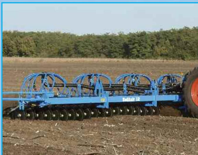
Сошниковый брус разделен на две части. За копирование почвы, которое является особенно важным при большой ширине захвата, отвечает инновационная гидравлическая система. Для этого сошниковый брус оснащен четырьмя сообщающимися цилиндрами, которые благодаря выравниванию давления обеспечивают правильное копирование почвы даже на ограниченных площадях. Давление сошников и глубина работы двухдисковых сошников с роликами ведения глубины просто регулируется при помощи гидравлики.
