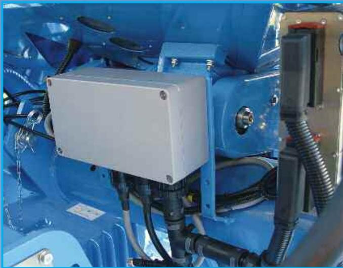
Расположенный под семенным бункером электромотор осуществляет надежный привод высевного вала и дозировочных узлов через цепной привод.
