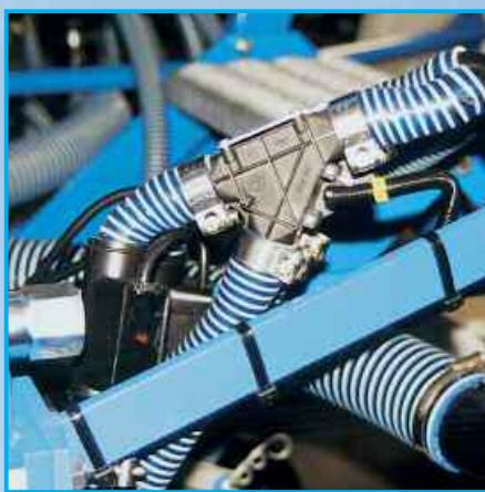
Датчики для контроля над технологической колеей или секциями расположены непосредственно позади распределителей и интегрированы в высевевые трубы. При этом под контролем находятся 2x4 ряда. В случае, если поток семян становится неравномерным либо прерывистым, водителю поступает звуковой сигнал. На дисплее одновременно с этим показывается номер забитого ряда либо секции, благодаря чему не нужно терять время на поиск забитого ряда.
