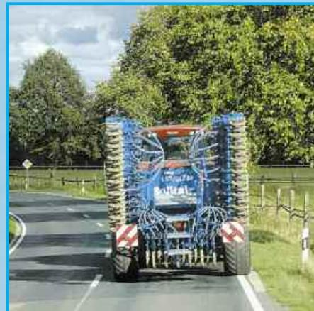
В навесном или полунавесном исполнении Солитэр 9 шириной захвата свыше 3 метров быстро складывается при помощи гидравлики на транспортную ширину, не превышающую трех метров; она может в любое время перемещаться с поля на поле безопасно и в короткие сроки. Требующая больших затрат времени и средств транспортировка на тележке больше не требуется. Благодаря отсутствию работ по погрузке на тележку производительность увеличивается до 20%.
