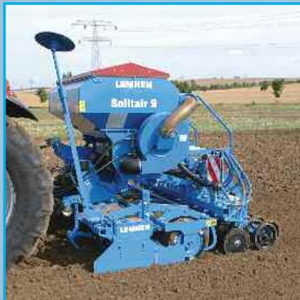
Пневматическая сеялка Солитэр 9 может навешиваться на все ротационные бороны Циркон и короткие комбинации Кварц ЛЕМКЕН. Наряду с не складываемыми версиями, Солитэр 9 может также быстро комбинироваться с ротационной бороной Циркон в складываемом варианте шириной захвата 4 и 6 метров соответственно. Все варианты можно применять самостоятельно с одним шасси.
