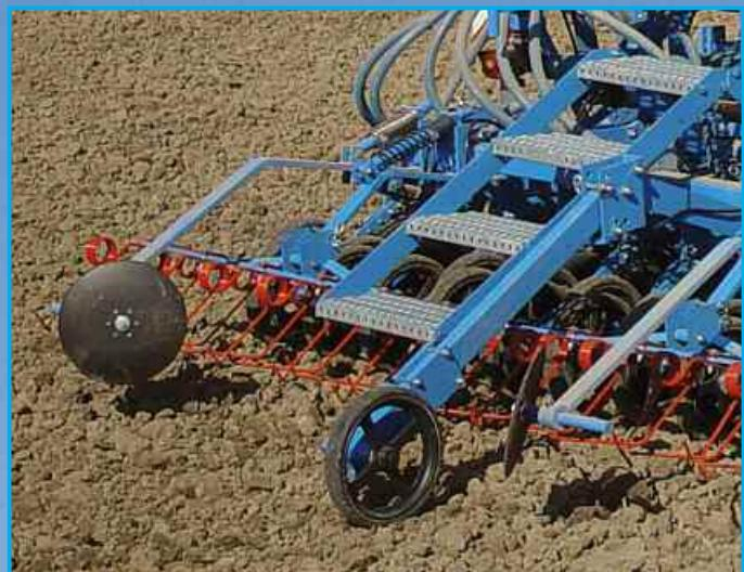
Импульсное колесо служит исключительно для измерения пройденного пути. Гарантировано движение без пробуксовок, так как движение колеса никак не связано с приводом высевного вала. Датчик на импульсном колесе служит для точного измерения пройденного пути. Импульсное колесо движется между двумя посевными рядами в пределах ширины сеялки и всегда по обработанной поверхности. За счет этого условия привода всегда одинаковы.
