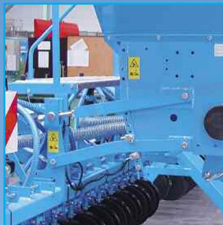
Различная глубина заделки семян регулируется бесступенчато при помощи двух шпинделей. За счет поворота стабильной рамы сошников изменяется положение прикатывающих роликов по отношению к двухдисковым сошникам и вместе с этим изменяется глубина заделки.
