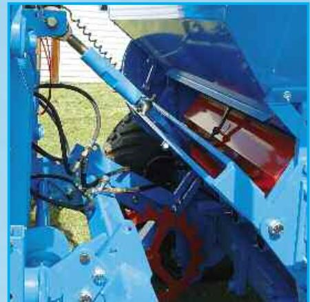
Замена сошникового бруса на агрегат точного высева возможна при помощи стандартной башни трехточечной навески для обоих навесных компонентов. Таким образом, возможна быстрая смена между технологиями посева.
