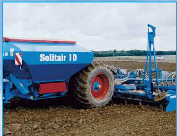
Большие шины (700/5030.5 1.500 x 700 мм) Солитэр 10 оказывают щадящее воздействие на почву и обеспечивают безопасную транспортировку. Колеса движутся перед почвообрабатывающим орудием и, возникающая от колес, колея рыхлится при помощи следорыхлителя и выравнивается ротационной бороной.
