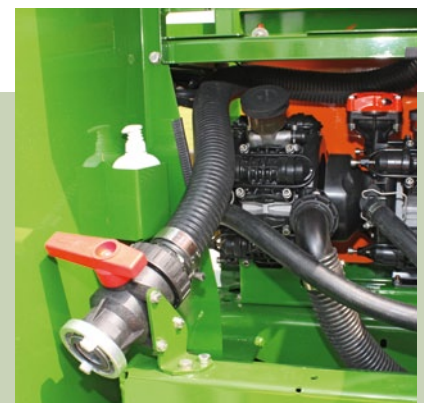
Заправка под давлением через (соединительное гнездо «С» или «Kamlok» муфта)
