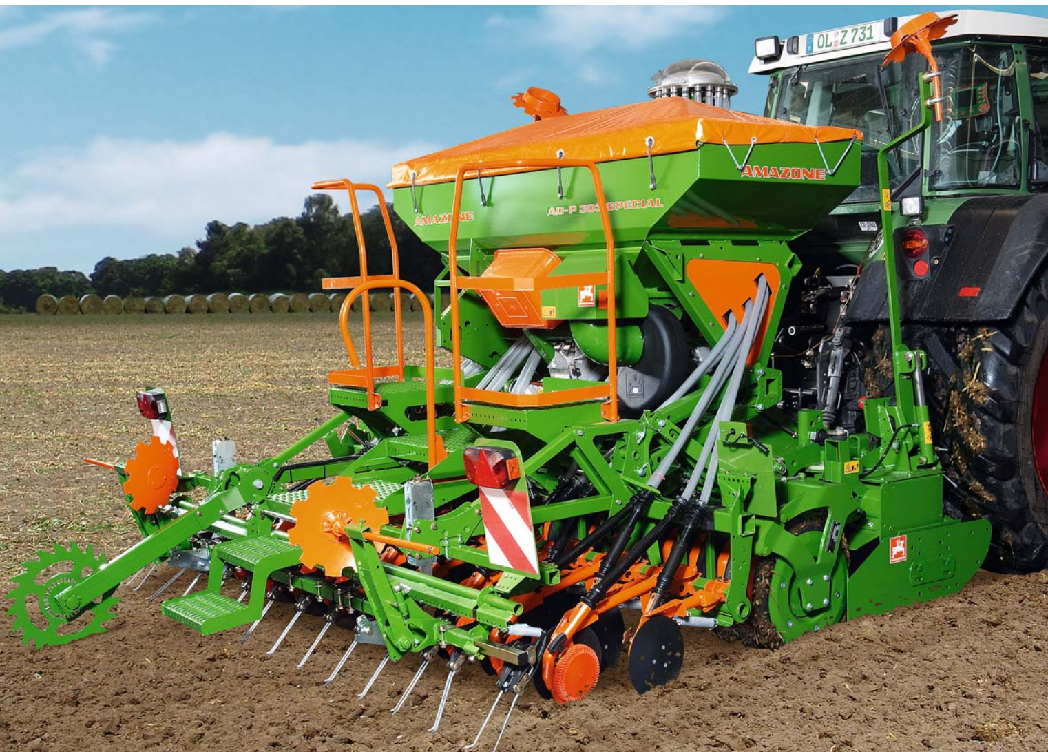
Зубья с агрессивным углом атаки
