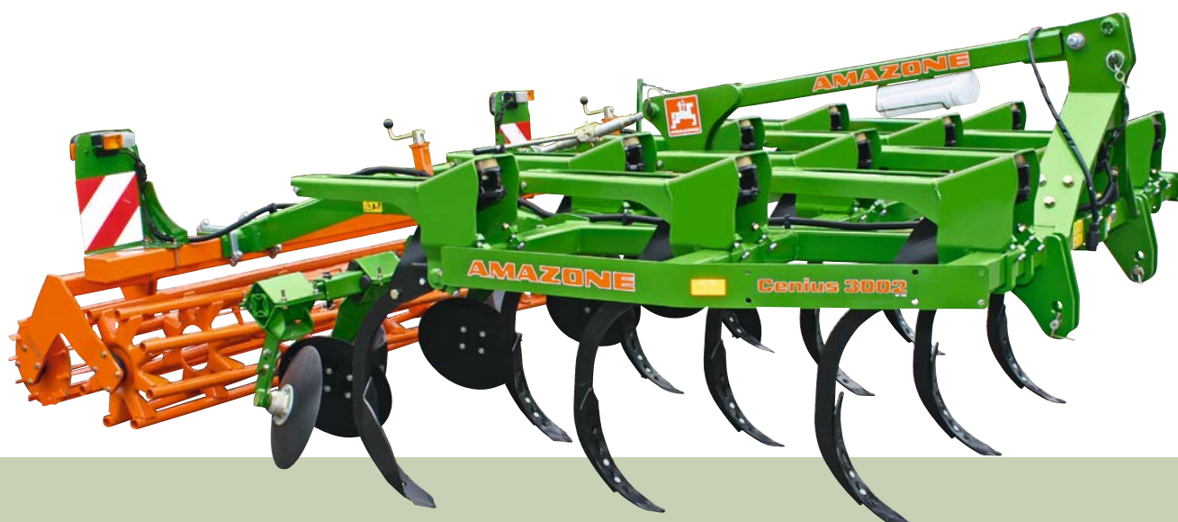
Cenius Super: Стойки-3D с предохранительным механизмом в виде пружинных демпферов
