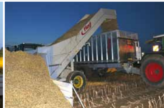
Стационарное перегружающее устройство „Universal“... ..и перегружающей производительностью от 25 т/ч
