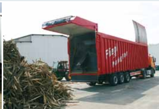
седельный выдвигающий вагон с объёмом до 90 м³
