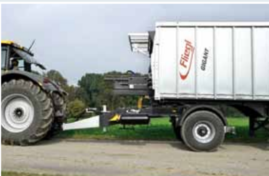
седельное устройство с гидравлически двигающимся полом для одноосной и тандем доли
