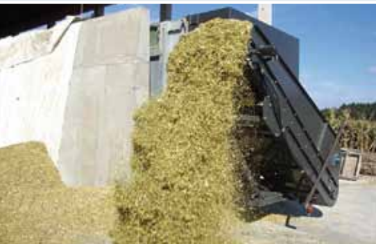
ленточный транспортёр с перегружающей производительностью до 12куб.м./мин.
