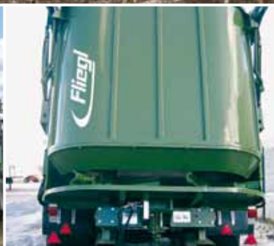
Разбрасывающий агрегат »Profi« (закрыт) с шириной разброса 22 м.
