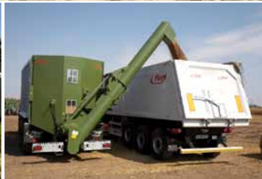
Перегружающий шнек для зерна с перегружающей мощностью до 350т./ч.
