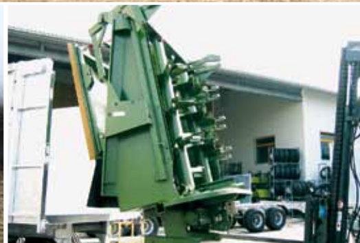
Установка разбрасывающего агрегата с помощью погрузчика в течении 10 минут.
