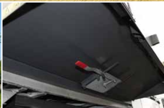
Задвижка контейнера большого объёма с разгрузочным люком
