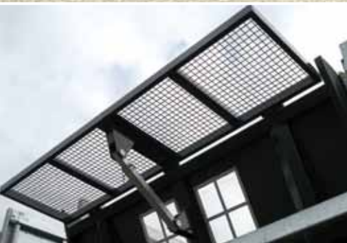
Решётка переднего борта (механически-серийно, гидравлически- по заказу).
