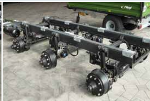
гидравлически подрессоренные оси
