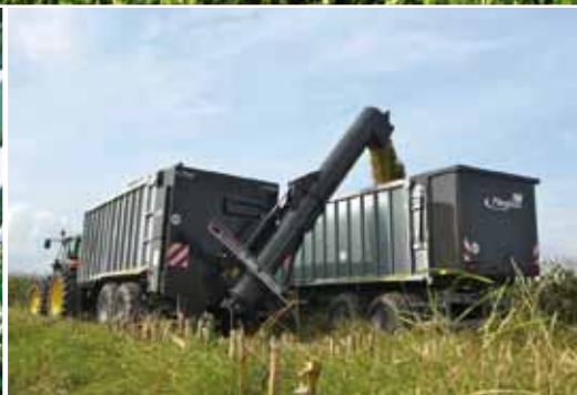
Перегружающий шнек для кукурузной массы с перегружающей мощностью до 14 куб.м./мин
