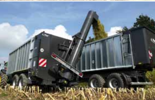
Перегружающий шнек для кукурузной массы с перегружающей мощностью до 14 куб.м./мин
