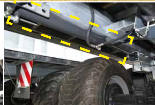
Гидравлически передвигающееся шасси.
