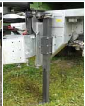
гидравлическая передняя опора
