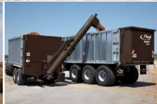
Перегружающий шнек с фрезами для силоса, использования шепы, сухого куриного помёта и.т.д. с перегружающей производительностью до 14куб.м/мин.
