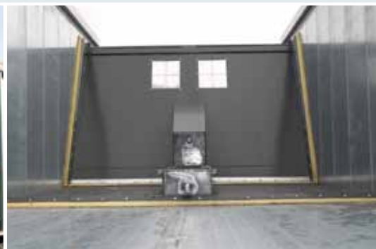
Уплотнители: абсолютно плотно для любого зерна. Полиэтерановые уплотнители установлены под углом 45°.
