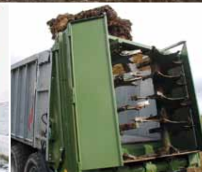
Dosieraggregat zur Trockenfermentierung
