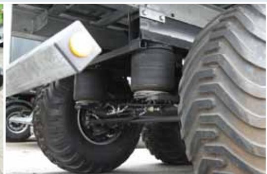
Подъёмный мост на воздушных подушках.
