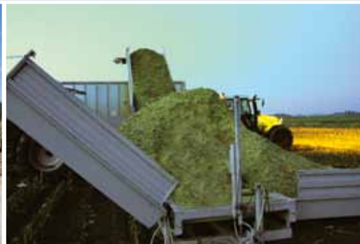
Стационарное перегружающее устройство „Universal“... ..и перегружающей производительностью от 25 т/ч
