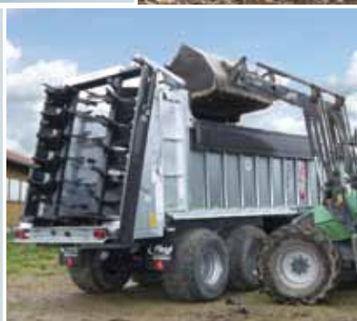
Разбрасывающий агрегат »Profi- Contract« (открыт) с шириной разброса 10-12 м.
