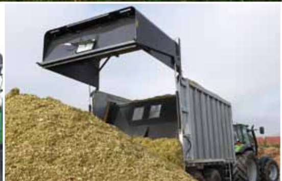
Гидравлически открывающаяся стенка (серийно).
